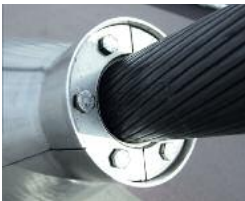
Figura 26: la corrosione galvanica non ha luogo tra tipi di inox diversi, anche se non hanno stessa resistenza a corrosione.
