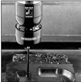
L'invenzione della sonda a contatto risale ai primi anni '70 ed ha rivoluzionato lo sviluppo delle macchine di misura a coordinate (CMM) come standard industriale per le misurazioni 3D.
