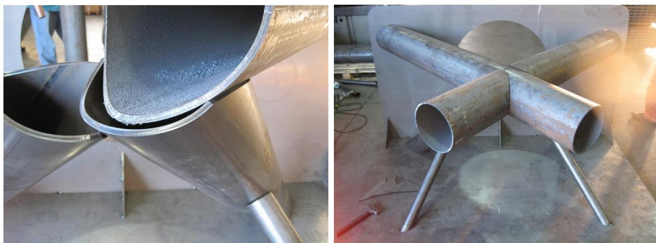
*Nodo campione per definire la preparazione dei lembi per la saldatura e le incisioni di riconoscimento e di riferimento per vincolare gli accoppiamenti fra i tubi – © CMM*
