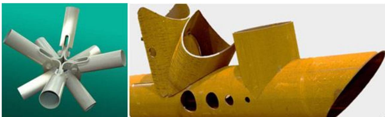
*Nodi tra profili cavi circolari realizzati attraverso lavorazioni laser 3D - © BLM Group (sinistra), © Tube Tech Machinery (destra)*
