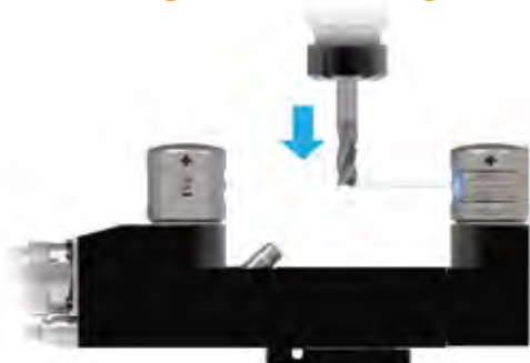
Presetting utensile laser
