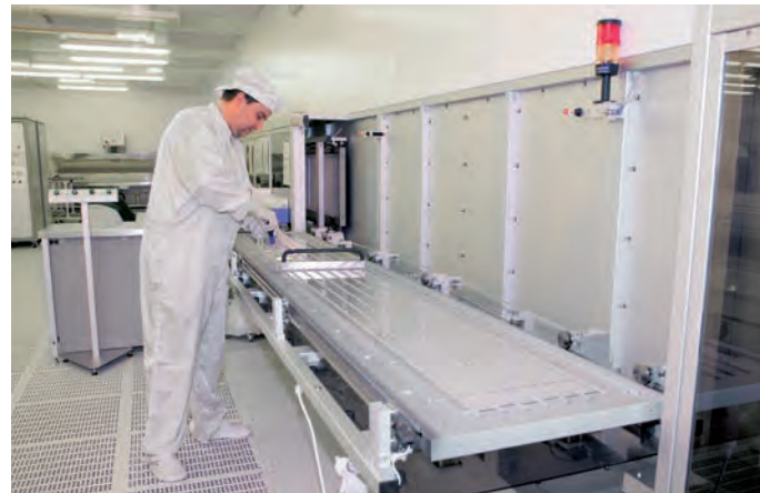
Impianto sottovuoto per l'applicazione di strati di cromo
