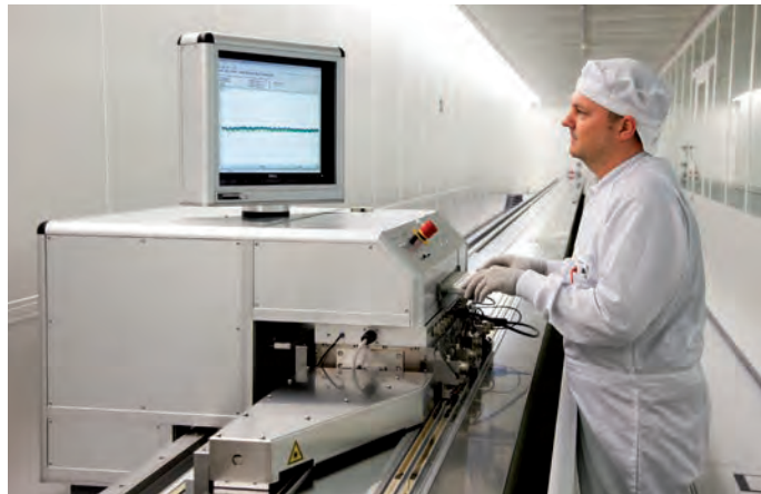
Banco di misura di 30 m di lunghezza per nastri graduati
