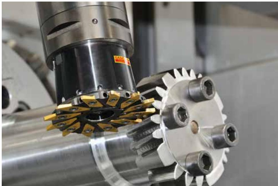
Con le frese a disco CoroMill® 161 e CoroMill® 162, ottimizzate per il processo e il software InvoMilling, scoprirete di poter lavorare i vostri componenti in modo altamente flessibile. Potrete usare gli stessi utensili per diversi profili d'ingranaggio e potrete iniziare a lavorare subito, senza aspettare l'arrivo di utensili speciali. Questa è la soluzione ideale quando si lavorano lotti di piccole dimensioni e quando flessibilità e riduzione dei tempi di lavorazione sono una priorità.
