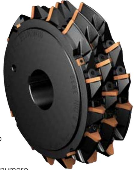
Queste soluzioni sono basate sul concetto di CoroMill® 172 (vedere a pagina 15) ma ottimizzate per i processi di fresatura delle cremagliere in termini di numero di denti e numero di dischi. Si tratta di soluzioni sviluppate per ottenere la grandezza necessaria quando si lavorano moduli tra M3.5–M10 in macchine speciali per la fresatura di cremagliere.
