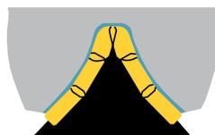
Fresa di sgrossatura a forma evolvente
