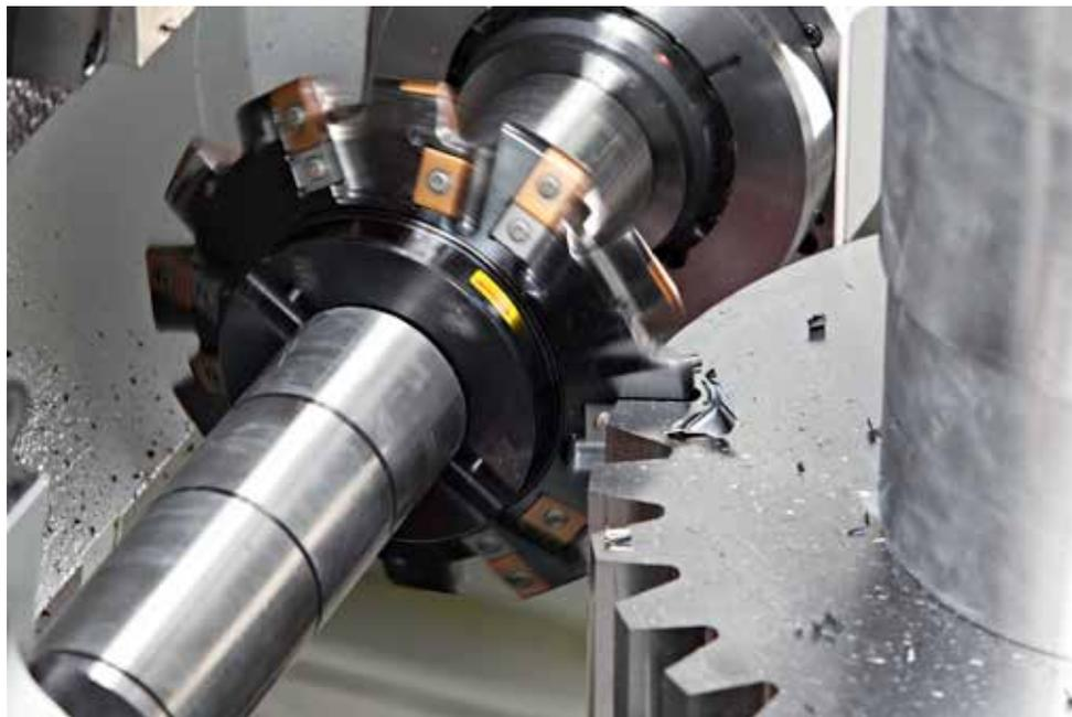
CoroMill® 170 è una fresa ad alte prestazioni per ingranaggi e pignoni di grandi dimensioni. Si tratta di una soluzione predefinita, con inserti standard disponibili in stock, per moduli di misura 12–22. In combinazione con le nostre qualità più recenti, CoroMill 170 riduce il tempo di lavorazione assicurando precisione e affidabilità nelle operazioni di sgrossatura di ingranaggi esterni e interni.
