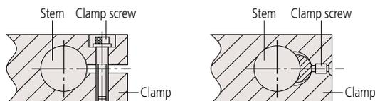
Diametro raccomandato per il foro di fissaggio: 15mm +0,034/+0,014
