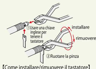
Il tastatore è intercambiabile in base all'applicazione. Quando si installa o si rimuove un tastatore, posizionare la chiave fornita nell'apposita scanalatura per evitare che il mandrino ruoti. Quindi afferrare il tastatore con le pinze per installarlo o rimuoverlo. Quando si afferra il tastatore con una pinza, inserire un pezzo di feltro o altro materiale morbido tra le griffe e la punta per proteggerla da eventuali danni.
