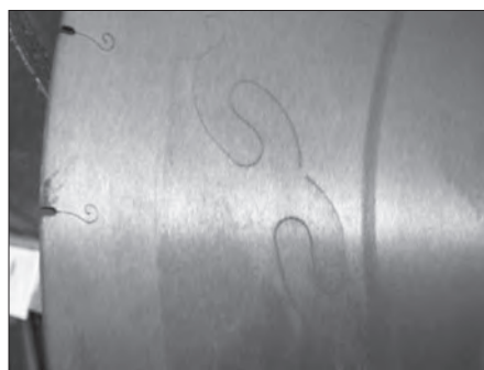
Figura Caso C: Disposizione sul disco delle fenditure antivibranti (Vibration damping slots)
