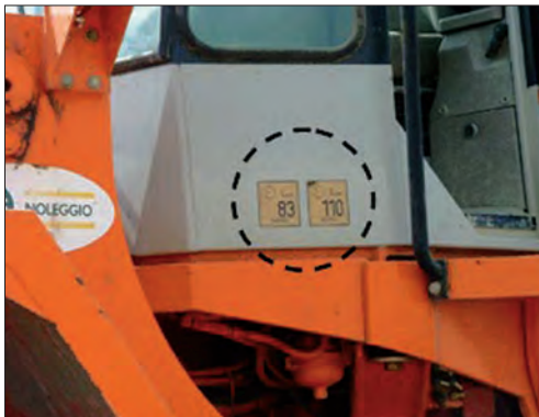
Figura 5.2: Targhette di informazione del livello di pressione sonora al posto di lavoro L_{pA} (sinistra) e di potenza sonora L_{WA} (destra) previste dalla normativa vigente fino al 31/12/02 per alcune macchine funzionanti all'aperto.
