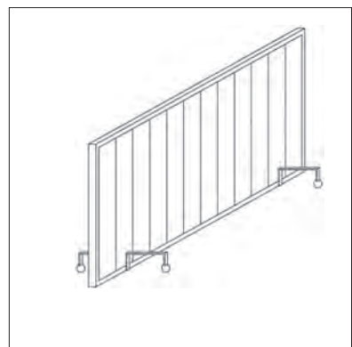
Figura 19.2: Esempio di applicazione di ruote per la movimentazione di schermi.
