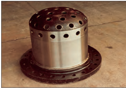
Figura 23.4: Particolare di un espansore per scarico vapore.
