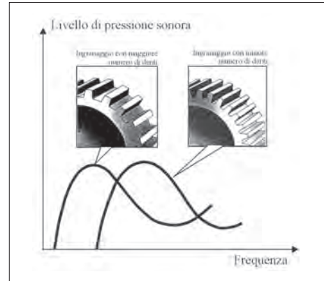
Figura 9.2: Effetto del cambiamento del numero di denti sulla frequenza di eccitazione delle ruote dentate
