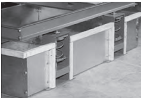
Figura 13.9: Esempio d'isolamento delle vibrazioni per "piattaforme" di lavoro.
