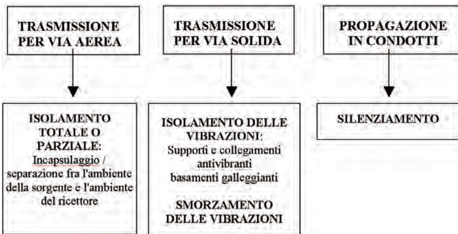
Figura 6.5: Tecniche di controllo della trasmissione sonora.
