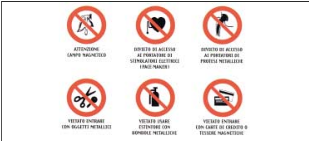
Fig36 Segnaletica CEM- DIVIETO.
