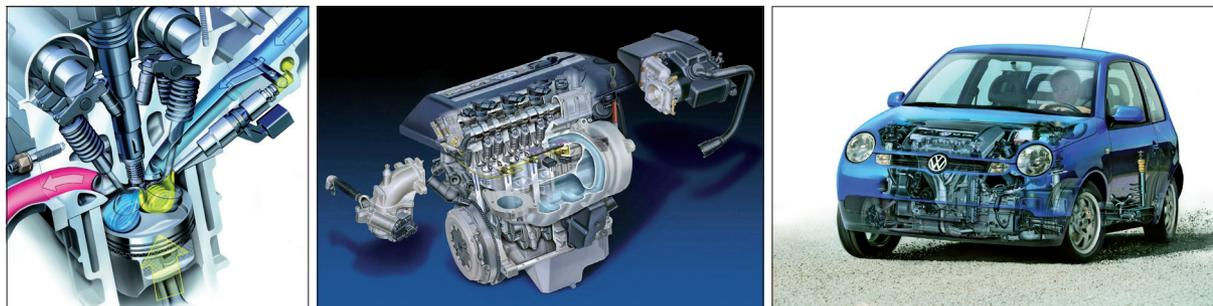
Fig. 42.12 - Sistema FSI (*fuel stratified injection*) sviluppato da Volkswagen per ridurre il consumo di combustibile: il combustibile viene iniettato in prossimità della candela d'accensione dando luogo a una zona con miscela ricca che facilita l'accensione mentre la propagazione della fiamma nel resto della camera di combustione avviene in una miscela povera [<http://www.youtube.com/watch?v=fvysuD5MFow>].
