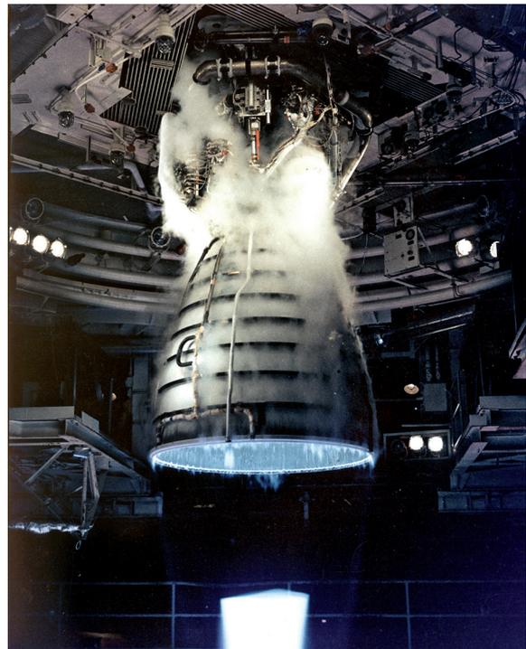
Fig. 40.9 - Il motore principale della navicella *Space Shuttle* provato al banco
