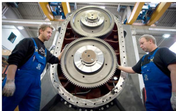
Fig. 37.31-b - Compressore Roots per portate molto alte (Aerzener).
