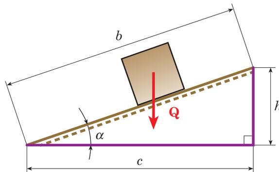
Fig. 5.13 - Piano inclinato su cui viene fatto scivolare il carico  $\mathbf{Q}$  per sollevarlo fino all'altezza  $h$ .
