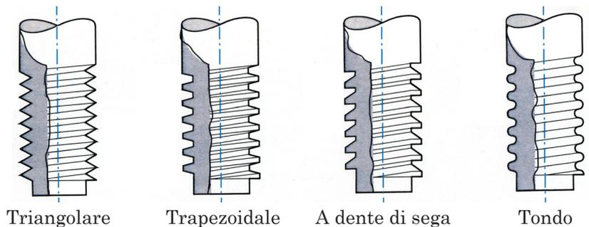
Fig. 5.21 - Vari tipi di profili di filettature.
