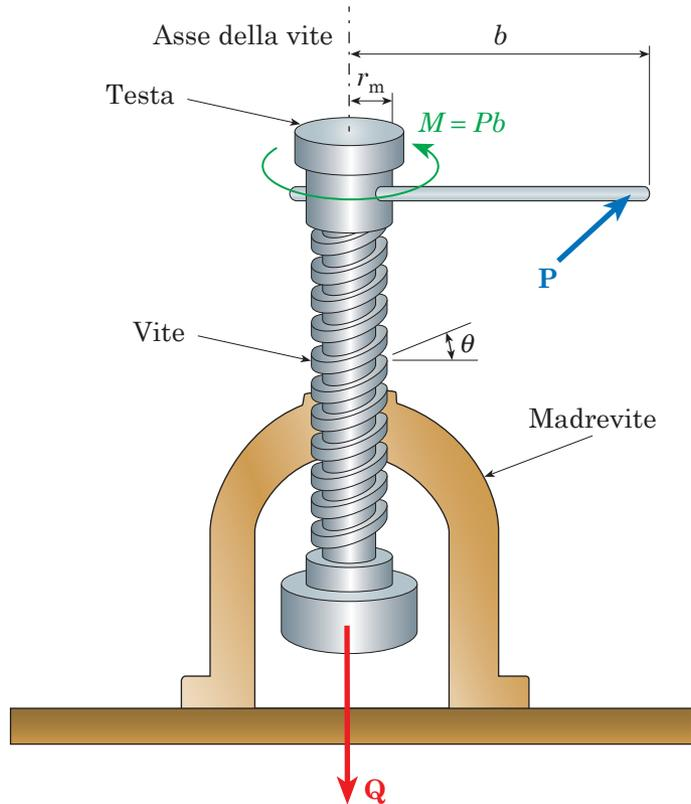
Fig. 5.19 - Particolare di vite e madrevite nella vite di manovra.
