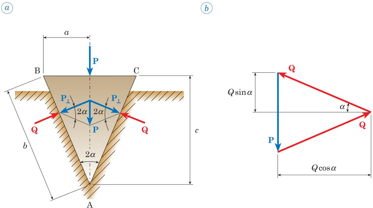
Fig. 5.18 - a) Scomposizione della forza motrice  $P$  che agisce sulla testa del cuneo nelle due componenti  $P_{\perp}$  normali ai fianchi del cuneo.
