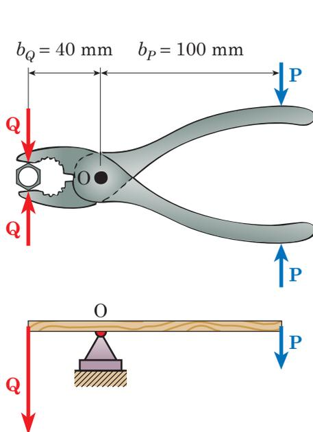
Fig. 5.3 - La pinza, che verrà trattata nell'Esempio 5.1, è una leva di primo genere.
