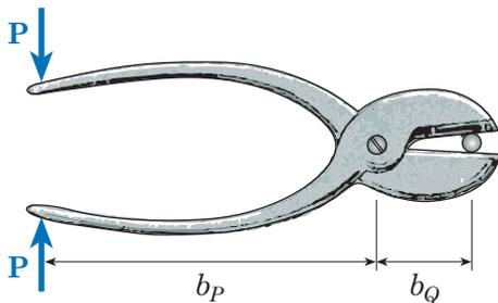
Fig. 5.1-a - La pinza è un esempio di macchina semplice: qui viene utilizzata per tagliare un filo.
