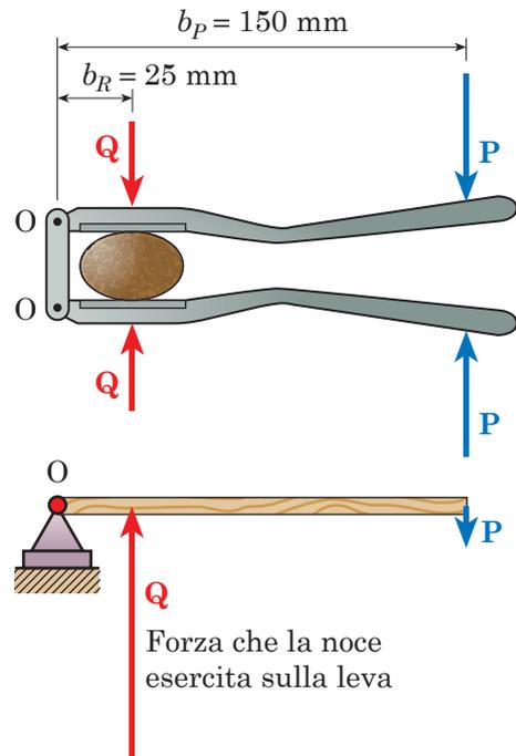
Fig. 5.4 - Esempio di leva di secondo genere: lo schiaccianoci, che verrà trattato nell'Esercizio 5.1.
