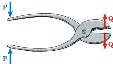
Fig. 5.1-b - Reazioni **Q** che il filo esercita sulle ganasce della pinza.
