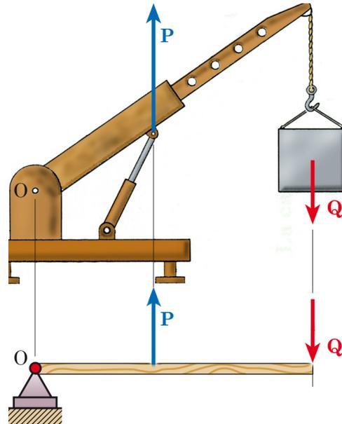
Fig. 5.5 - Esempio di leva di terzo genere: braccio della gru.
