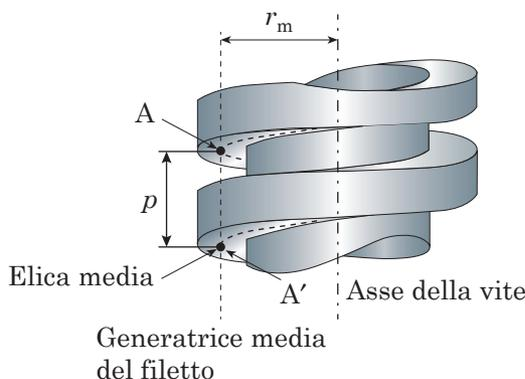
Fig. 5.22 - Elementi caratteristici di una vite con indicati il passo  $p$ , il raggio dell'elica media  $r_m$  e l'angolo  $\theta$  di inclinazione dell'elica.
