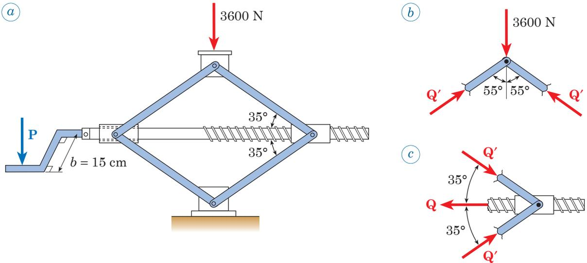
Fig. 5.25 - Cric a parallelogramma articolato trattato nell'Esempio 5.4.
