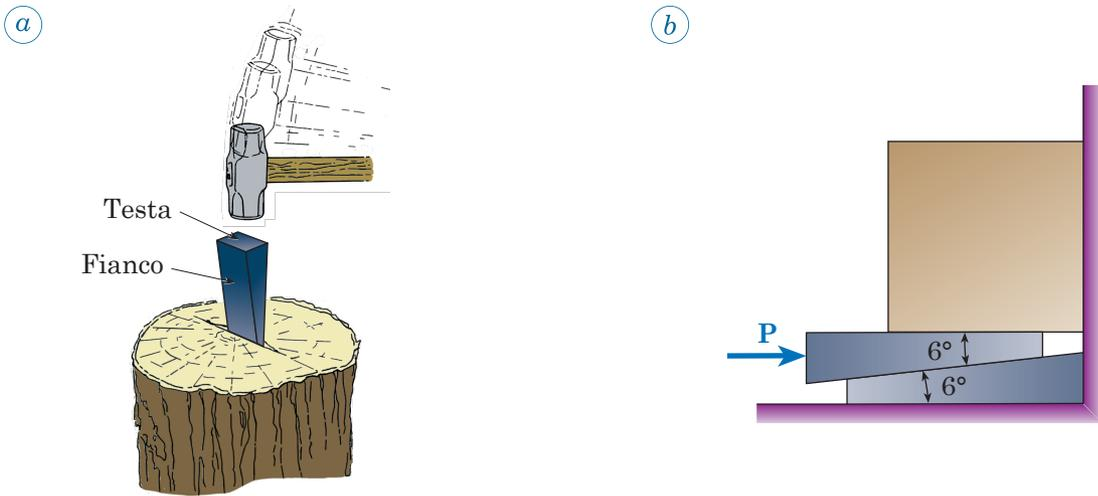
Fig. 5.17 - a) Cuneo con tagliente utilizzato per spaccare un ceppo di legno.
