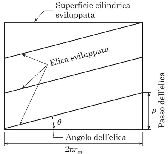
Ottenimento di un'elica su una superficie cilindrica
