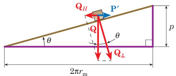
Fig. 5.24 - La vite può essere schematizzata come un blocco su un piano inclinato.
