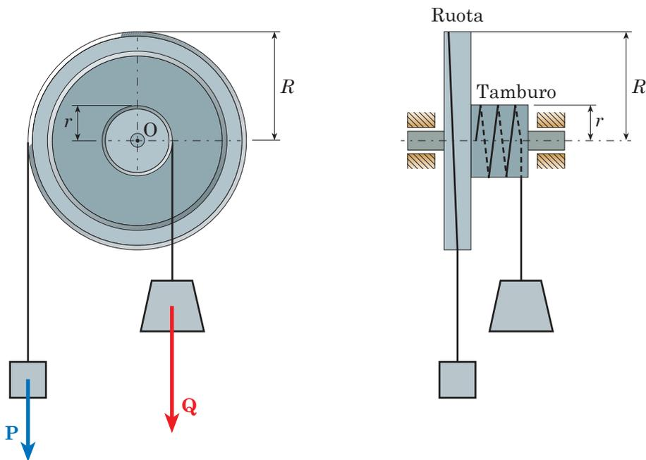
Fig. 5.10 - Verricello semplice: due cilindri di raggio diverso che ruotano intorno al loro asse comune.
