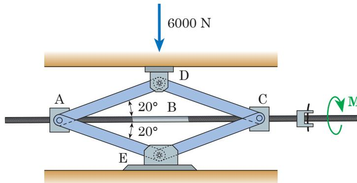
Fig. 5.33 - Cric a parallelogramma trattato nell'Esercizio 5.14.
