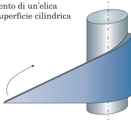
Fig. 5.23 - Sviluppo della superficie cilindrica relativa a una spira dell'elica media: sono indicati l'angolo  $\theta$  di inclinazione dell'elica, il raggio medio  $r_m$ , la circonferenza di base  $2\pi r_m$  e il passo  $p$ .
