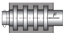
Perno di spinta ad anelli multipli.
