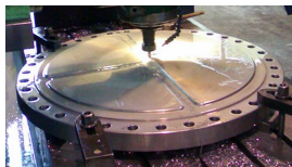
Coperchio di serbatoio in pressione.
