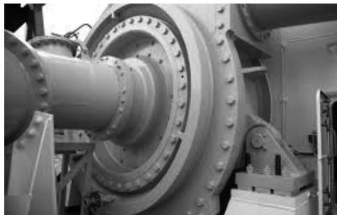
Figura 6 Pompa centrifuga da dragaggio ( dredge pump ).
