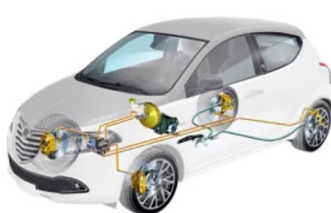
Figura 13.4 Impianto frenante di un autoveicolo (schema).
