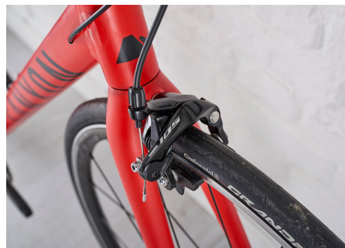
Figura 13.7 Impianto frenante per bicicletta.
